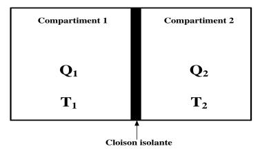
Si on enlève la cloison, dans quel sens va s'écouler la chaleur ? Pour cela déterminons le signe de  $Q_1$  et  $Q_2$ . On a :
