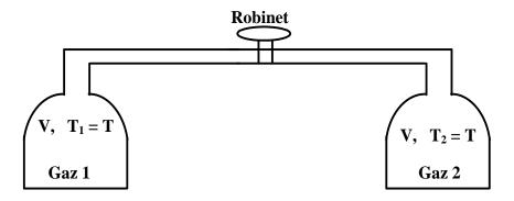
Soit  $T_f$  la température finale commue aux 2 gaz lorsqu'on ouvre le robinet.
