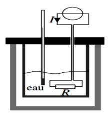
On prend comme système le calorimètre et tout ce qu'il contient soit la masse m d'eau et la résistance. On suppose pour simplifier les écritures que les capacités thermiques de la résistance et du calorimètre sont négligeables devant celle de l'eau. Les variations d'enthalpie et d'entropie du système sont donc pratiquement égales à celles de l'eau seule. Quel est l'état final de l'eau ?
