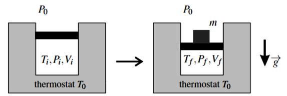
On prend pour système le gaz et le piston. On appelle n la quantité de gaz. La transformation est monotherme car le gaz ne reçoit de transfert thermique que du thermostat de température  $T_0$ . Elle n'est pas isotherme car elle est brutale et que la température du gaz n'est pas toujours définie.
